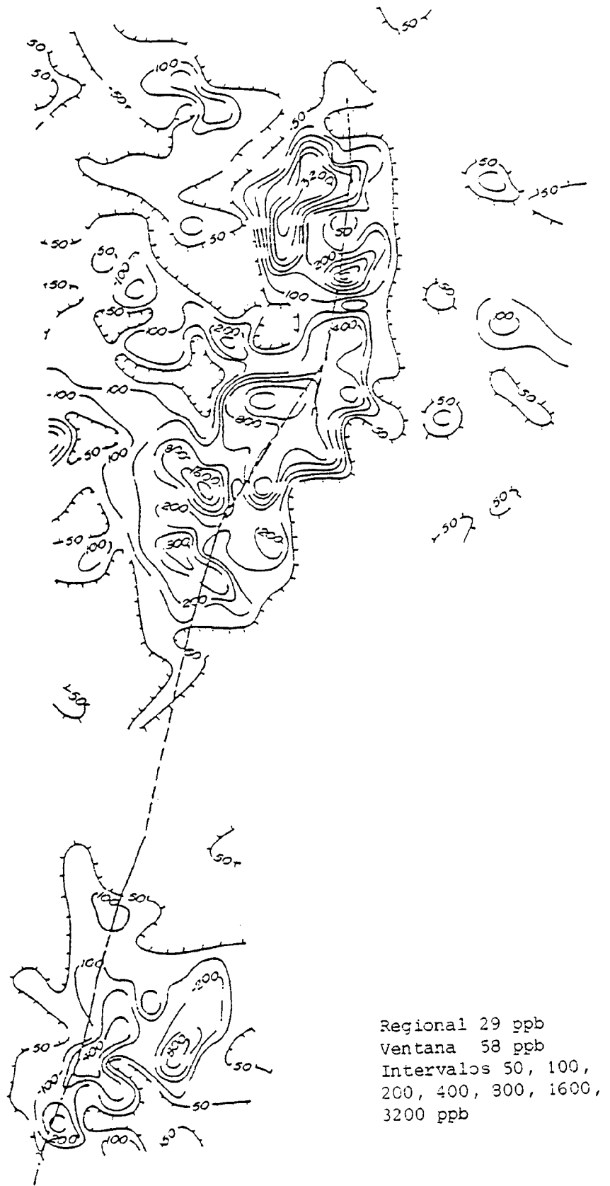
FIGURA 8.11. DISTRIBUCION DE MERCURIO SOBRE EL CAMPO GEOTERMICO ROOSEVELT HOT SRPINGS, UTAH (Christensen et al., 1983).
